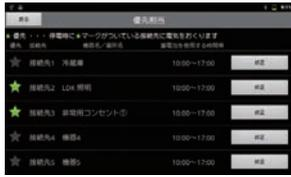
配線された系統毎に蓄電池の毎日の使用する時間帯を自由に設定できます。また、停電時には、★印のON/OFFで使用する、しないが設定できます。
