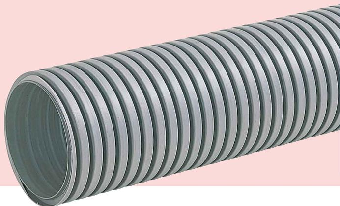
フレキシブルに曲がる下水道取付管。曲管を使わなくても、既設物が容易に回避できます。定尺5mで接続箇所が少なく、また市販の取り付け支管・樹脂マスにワンタッチで接続できるなど、優れた作業性で工期短縮・工費削減に効果を発揮します。
