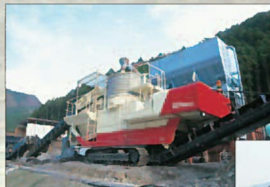
SR-P1800特殊仕様機：SR-P1200をベースに混合機容量を拡大させた仕様。処理能力は向上しますが、適応土質が限られます。
