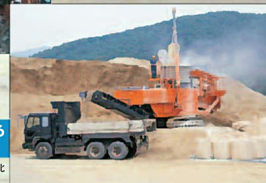
SR-P1800特殊仕様機：SR-P1200をベースに混合機容量を拡大させた仕様。処理能力は向上しますが、適応土質が限られます。
