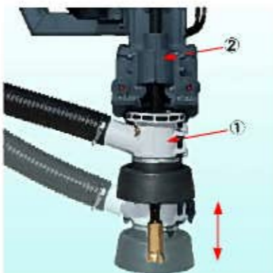
①スライド式サクショフフード サクショフフードが上下にスライド。掘り粉の捕集が確実で、せん孔のロウ処理作業も容易に行えます。 ②油圧式セントラライザ
