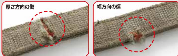
※写真は実際に屋内工場で使用されていたキトーベルトスリングで、破損時のイメージです。
