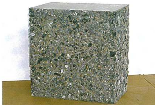
土木：打ち継ぎ面処理
