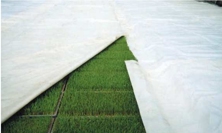
ポリエチレンに無数の空気の泡(独立気泡)を閉じ込めた、断熱効果の高い低発泡ポリエチレンのシートです。
